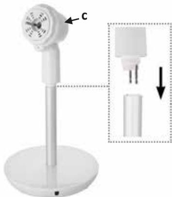
3. Fissare la testa del ventilatore sull'unità motore.
